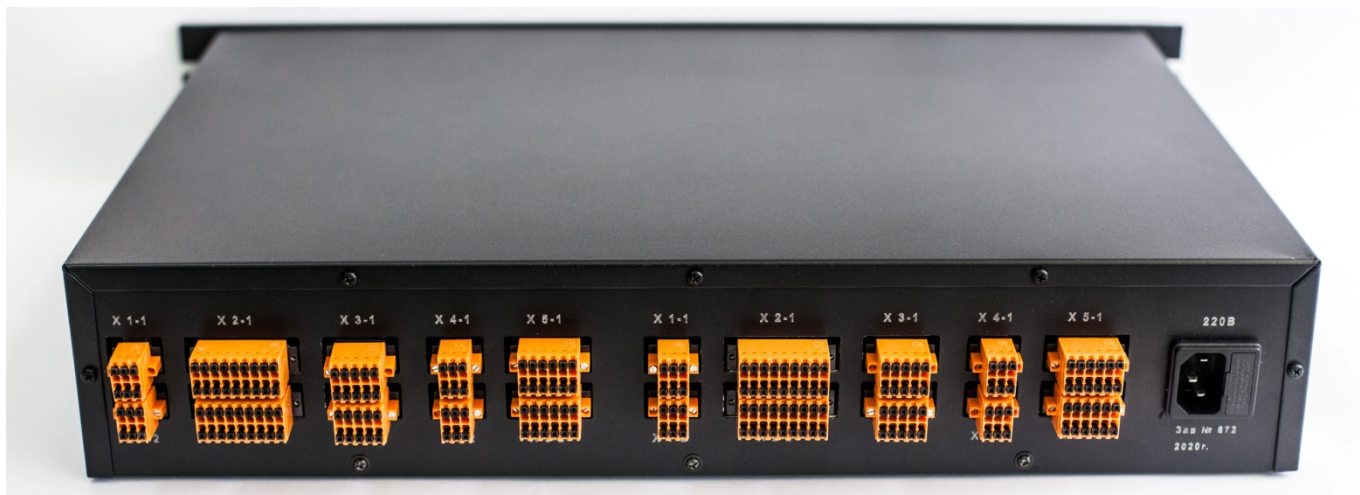
Рис. 3. Задняя панель изделия с гнездовыми разъемами.
