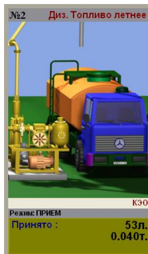
Рисунок 11 – Элемент управления стояком в режиме приема нефтепродукта.
