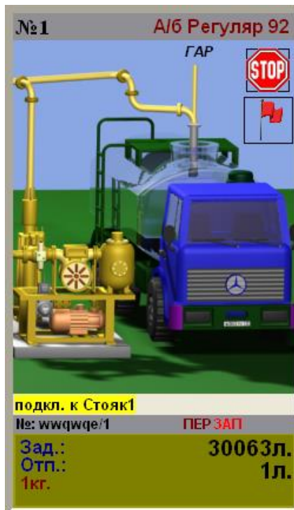
Рисунок 9 – Элемент управления стояком в режиме отпуска нефтепродукта. Верхний налив.
